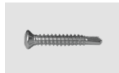
Vis autoperceuse 3,9x19 mm pour la fixation de : • Structure support en alu avec Clips pour plots de terrasse • Raccordement longitudinal • Raidisseur transversal
