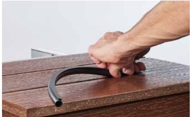
Händische Montage durch Eindrücken
