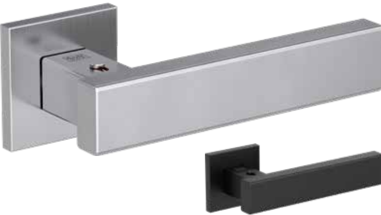
fast2fix-Technik, Türstärke: 38-50mm, Vierkantart: Hohlstift, Vierkant Abmessungen: 8mm
